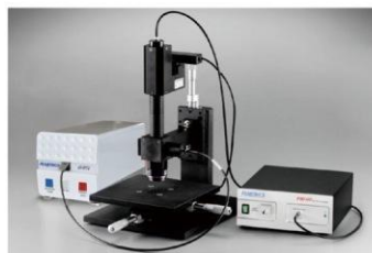
F40适用于微区的薄膜测量
